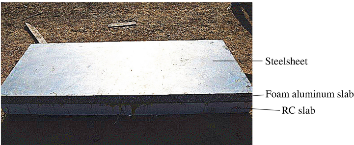
图 3 含泡沫铝保护层的钢筋混凝土板
