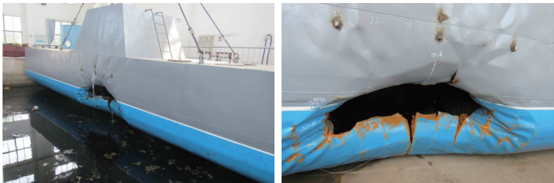
图 15 舷侧近距离爆炸下舱段模型毁伤结果
