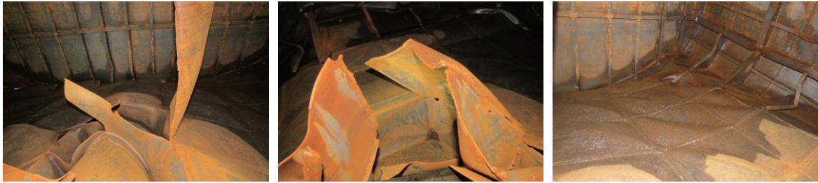
图 8 内底板破坏变形结果
