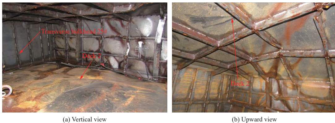
图 9 甲板 2 毁伤破坏结果
