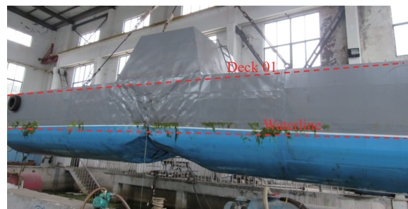
图6 底部近距离爆炸后舱段模型整体毁伤结果
