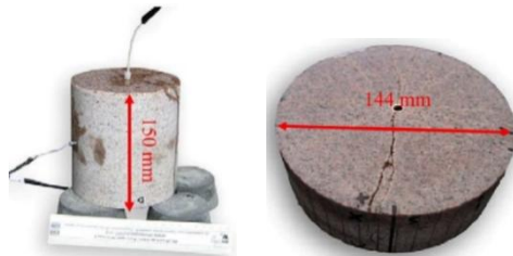
图 1 Dehghan 微型岩体爆破模型试验
