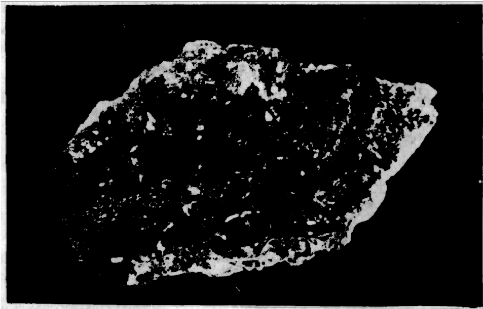
图3 PS-4的冷凝玻璃体，呈炉渣状，气孔发育，颜色不均匀
