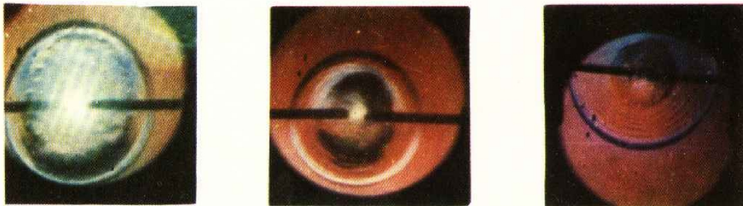
高速彩色刀口纹影法半定量测电爆驱动空气击波强度
