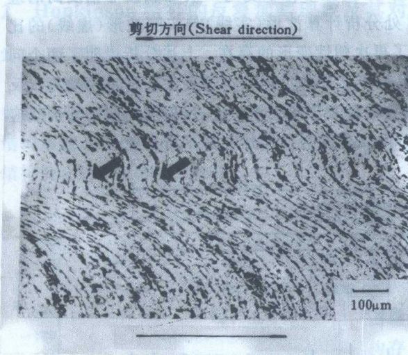
图3 标准扭杆上为反复加载破坏的20号钢剪切 局部化微结构形态(箭头所示反“S”型扭杆)
