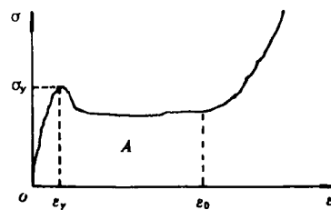
图 4 泡沫的吸能缓冲机理 Fig. 4 The mechanism of energy-absorption and cushioning action 即材料的屈服点以及粉末压实起始点仅仅与 RPUF 的密度有关,而与应变率无关。
