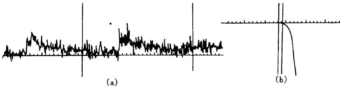
图4 (a)压力传感器记录;(b)AlO特征谱线强度
