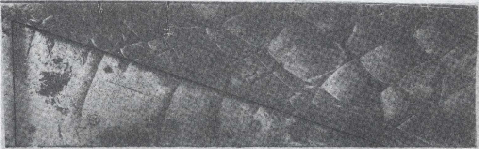
图4 爆轰波绕射 19.3^\circ 楔块时胞格结构烟迹记录照片( 2\text{H}_2+\text{O}_2+\text{Ar} , \gamma=1.447 , p_0=16\text{kPa} , M_0=5.12 , 分界线在楔块顶点上游开始形成)
