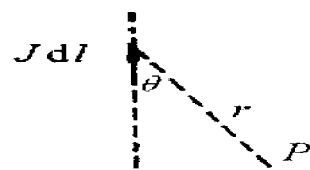
图 5 磁流元引起电场的计算用图
