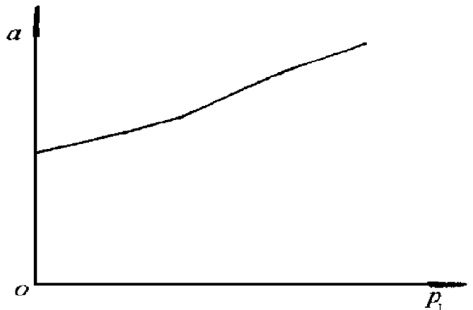
图 2 高压气室压力与最大加速度的曲线 Fig.2 Max. acceleration distributions at different high pressure chamber
