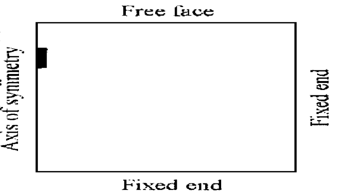
图 1 简化的爆破模型 Fig.1 Simple blasting model
