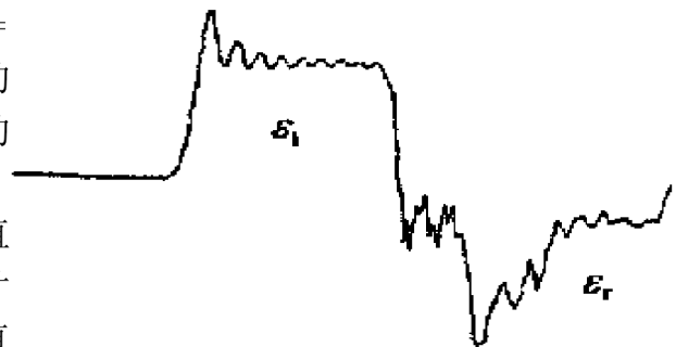
图 6 直锥变截面杆中的原始波形
