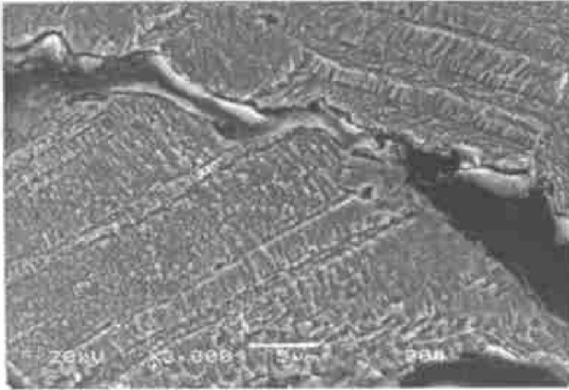
图 15 加围压:石墨+少量孔洞+铜基体上孪晶(腐蚀) Fig. 15 Confined pressure sample: twin crystal of Cu-matrix (corrosive)
