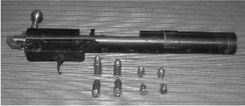
图 1 弹道枪、弹与弹头照片
