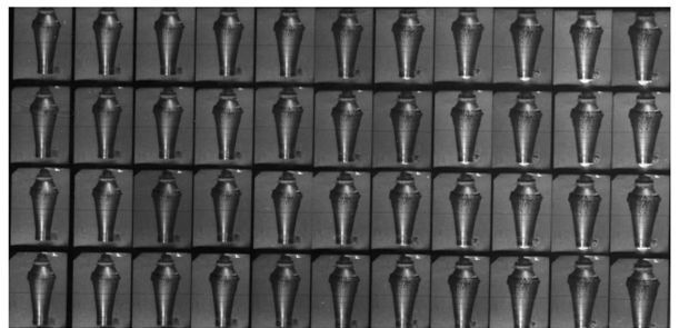
图 4 20 钢膨胀破裂过程 Fig. 4 Experimental results of steel
