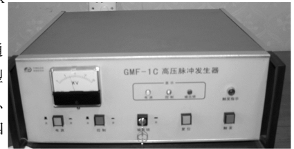
高压脉冲发生器
