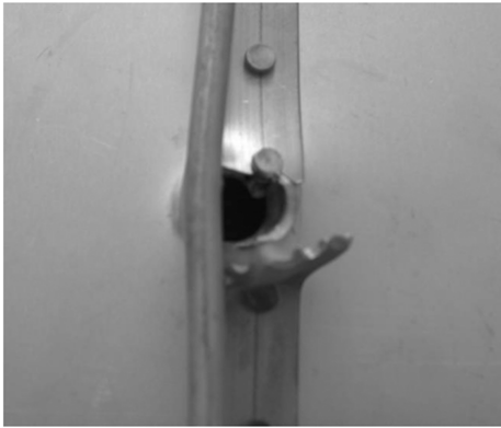
图11 II型加筋结构实际的弹穿损伤
