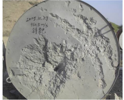
图10 串联战斗部斜侵彻混凝土靶的实验照片
