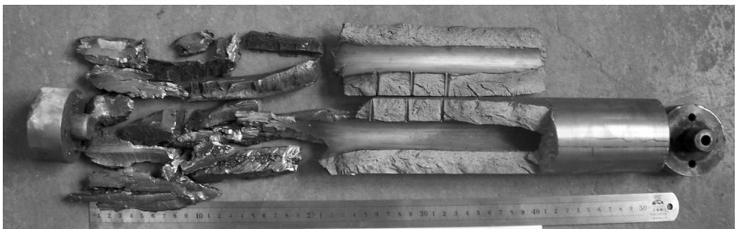
图 7 实验 2 回收的 DDT 管碎片
