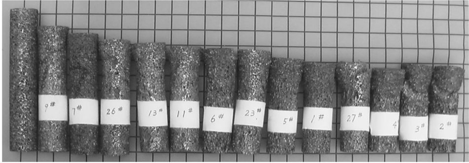
图 4 部分试件的变形图像(从左向右撞击速度增大)
