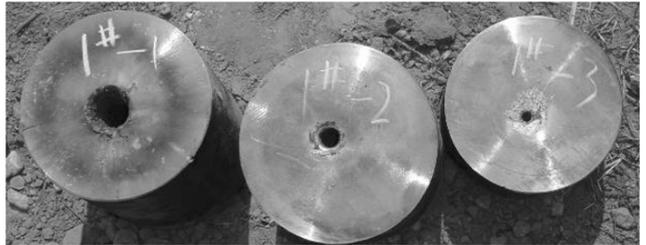
图 8 两种前级装药侵彻钢锭实验照片
