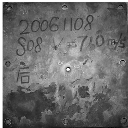
图 9 加胶木 7.62 mm 步枪子弹正撞击靶板的正、背面冲塞孔
