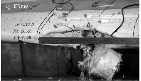
图 1 国产运七型飞机的鸟撞实验
