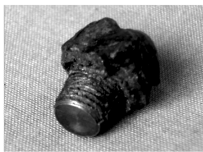
图 4 实验 5 弹孔纵剖面和残余弹芯
