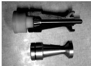
图1 弹芯及弹托结构 Fig. 1 Penetrator and sabot
