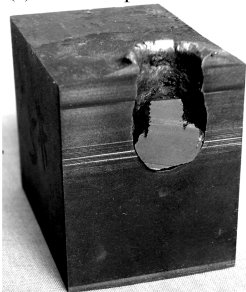
图 4 实验 5 弹孔纵剖面和残余弹芯
