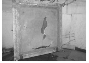
图 4 拉伸破坏试验模型照片
