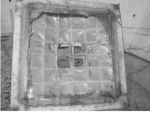
图 5 剪切破坏试验模型照片
