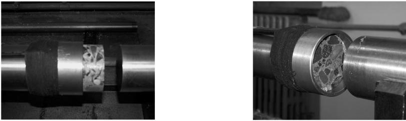
图 3 套筒、试件、压杆组装照片
