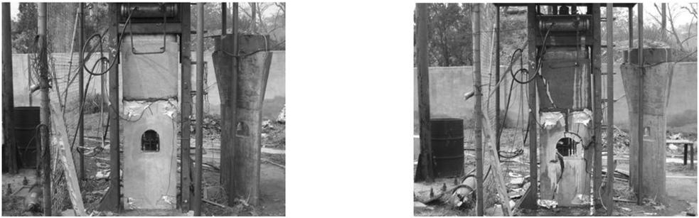
图 4 内层加装钢板的试件在实验前后的形态
