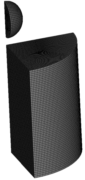
图 1 有限元几何模型及网格划分示意图 Fig. 1 Geometry model and meshing of particle and substrate
