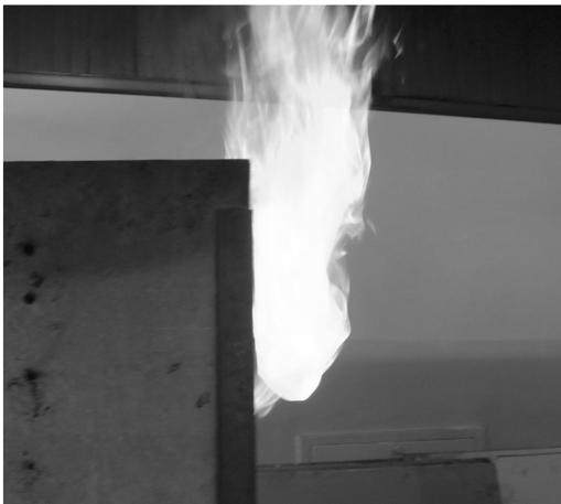
图 3 强轰燃实拍照片 Fig. 3 Practical photo of strong flashover
