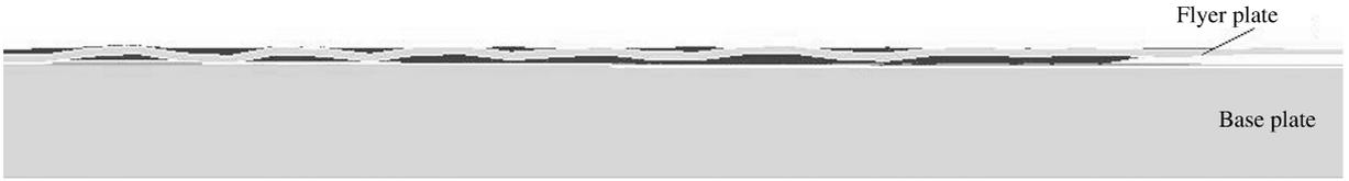
图 2 复板边缘褶皱区域侧视图( $t=1.44\text{ ms}$ )
