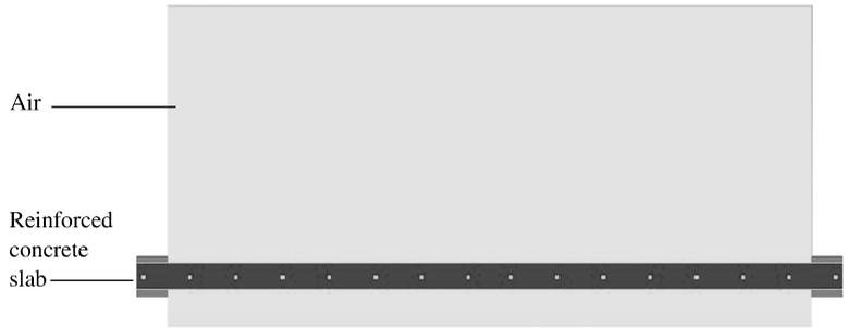
图 7 有限元数值模型的剖面图
