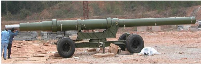
图 3 口径为 320 mm 的平衡炮
