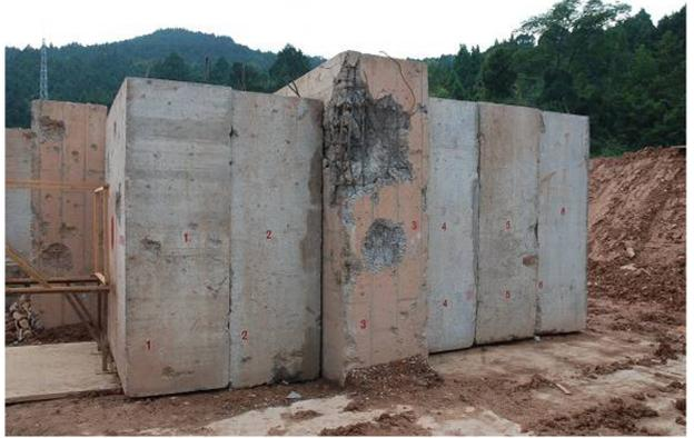
图 2 钢筋混凝土靶
