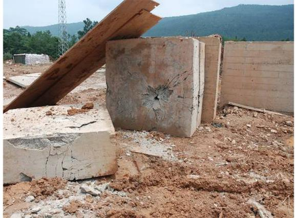
图 6 混凝土靶标的破坏情况
