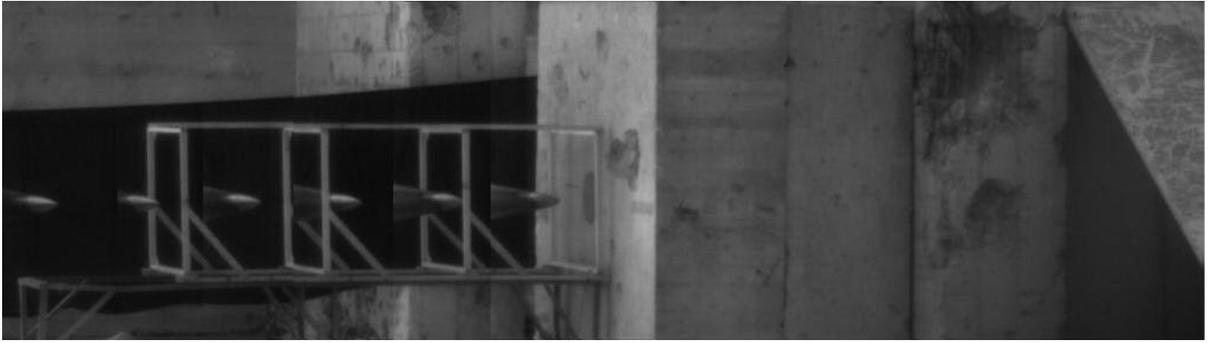
图 5 弹体飞行过程图像
