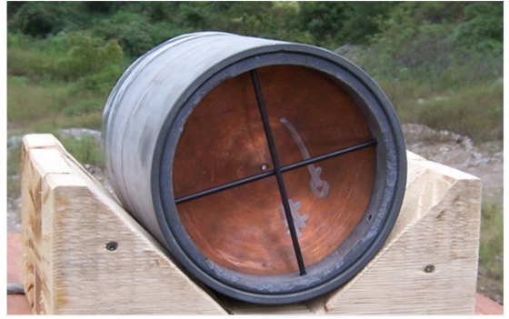
图 1 切割式 MEFP 战斗部实验照片
