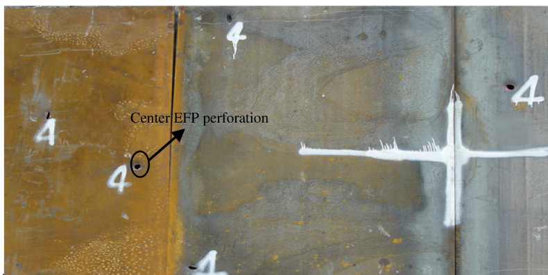
图 4 钢靶上弹丸穿孔图
