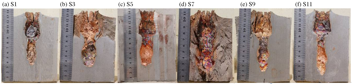
图 4 不同装药间距串联 EFP 装药侵彻钢靶实验结果
