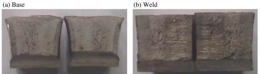
图 2 母材试样和焊缝试样的宏观断口照片
