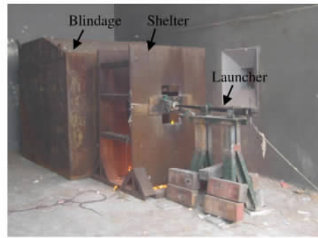
图 2 破片撞击装药实验现场
