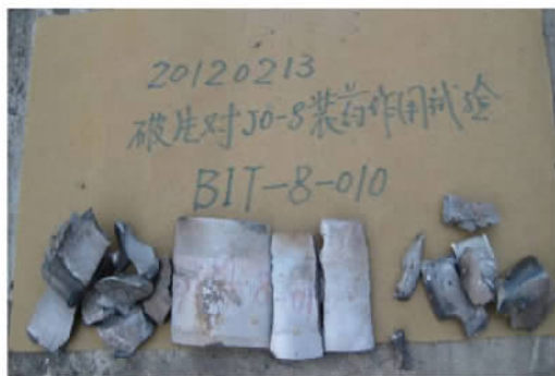
图 3 破片速度为 v = 1\ 093.0 m/s 回收的钢筒碎块
