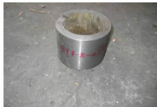
图 4 破片速度为 v = 492.5 m/s 时回收的空钢筒
