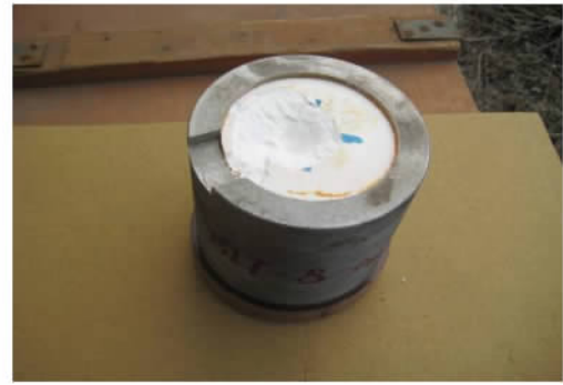
图 5 破片速度为 v=420.1 m/s 时钢筒内装药破损
