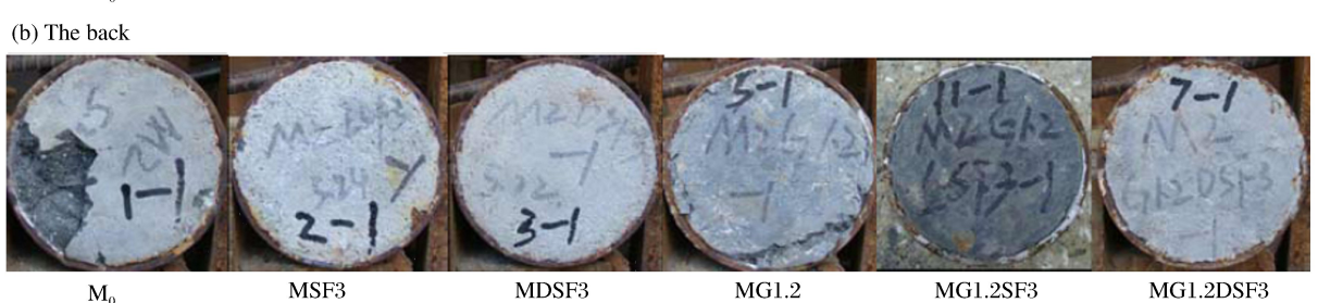
图 2 第 1 次侵彻后不同靶体破坏形态
