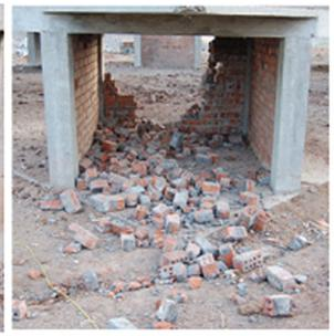
图 8 第 11 炮后实验墙的破坏形态
