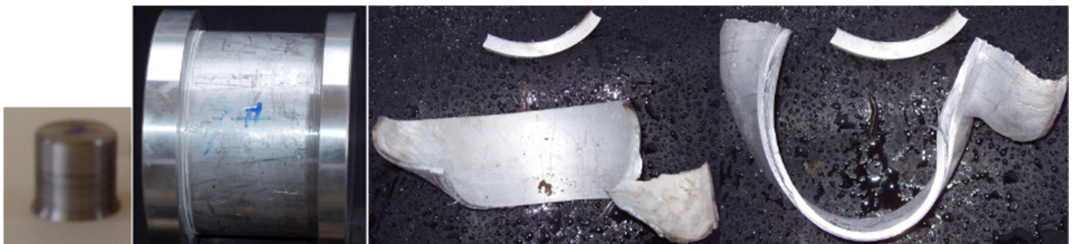
图 13 破片、带壳炸药和装药引爆、半爆后壳体碎片
