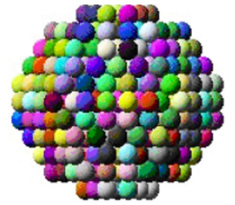
图 2 球形颗粒的离散模型 Fig. 2 The discrete model of spherical grains
