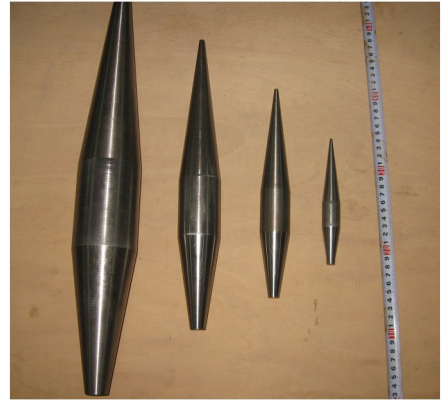
图 1 不同杆径 SHPB 实验装置对应的冲头系列
