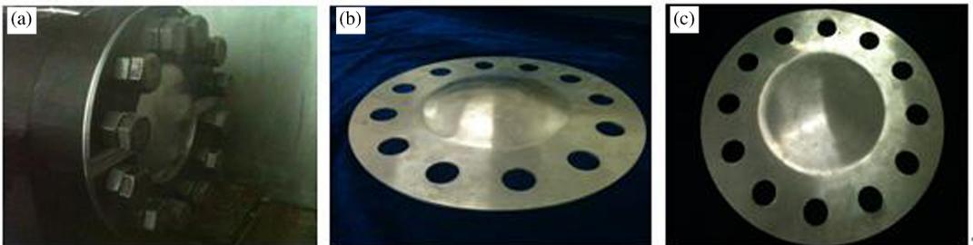
图10 5A06铝合金靶板加载前后形貌
