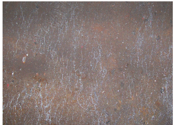
图 5 空中爆炸后遗留的铝纤维碎屑
