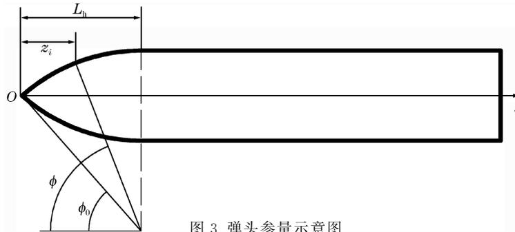
图 3 弹头参量示意图
