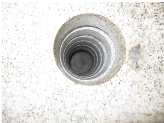
图 3 装药孔壁的环形嵌槽
