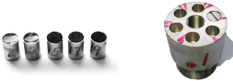
图 1 火炮过载实验样品与工装
