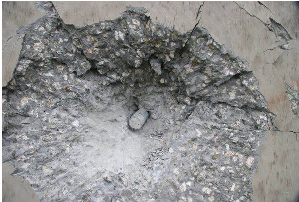
图 2 火炮混凝土过载实验侵入图片及记录曲线
