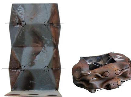
图 10 预折纹管变形前后对比
