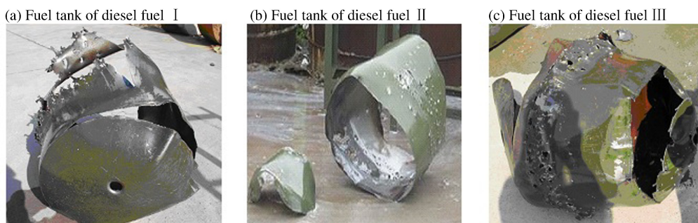
图 6 油箱毁伤情况
