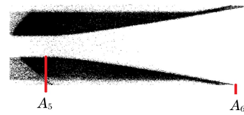
图 3 圆筒壁膨胀的扫描底片
